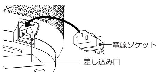
差し込み口と電源ソケットの隙間が約2mmになるまで本体を押さえながら差し込んでください。
